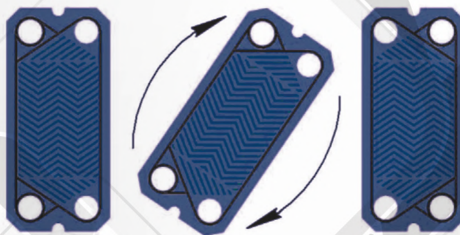
Рисунок 2 - Поворот пластины на 180°
